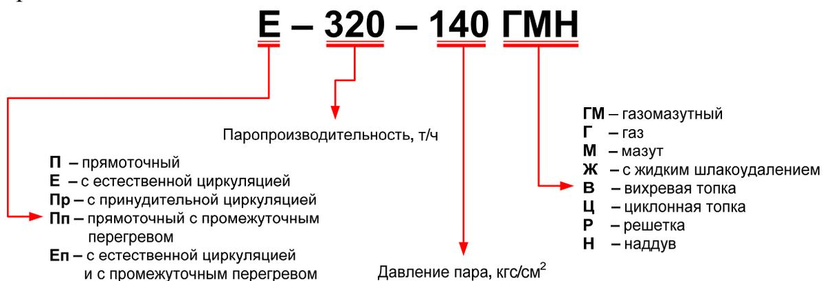
Рис. 2.6. Маркировка паровых котлов
